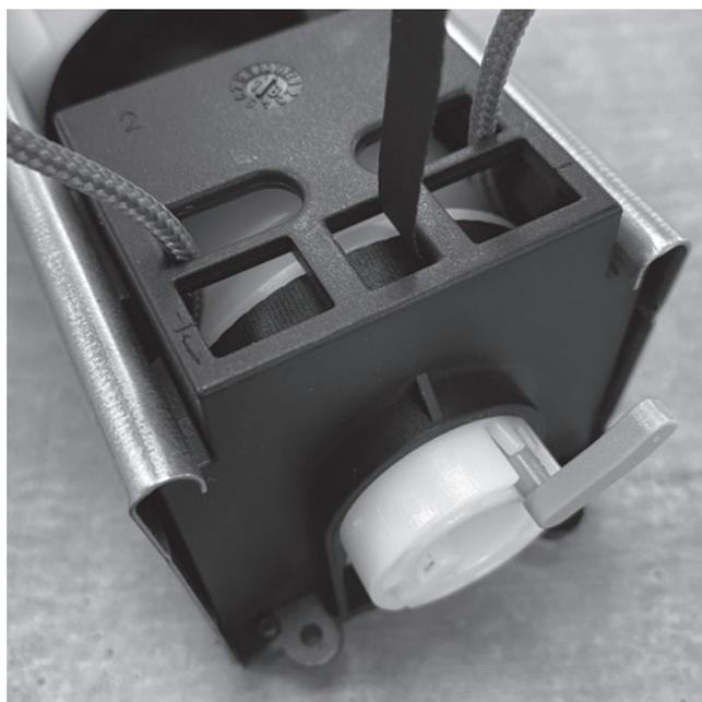
Man muss zuerst das komplette Texband vom Rad durch Motor oder Getriebe abwickeln, solange drehen bis sich die Richtung der Texbanddrehung nicht ändert – bei gleicher Drehrichtung (Bewegung nach unten) beginnt der Texband sich wieder einzuwickeln.
