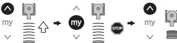
**i** Wenn die Außenjalousie den Schalterfühler berührt, bestätigt sie mit einer kurzen Auf-/Abbewegung und die obere Endlage wird ca. 6 mm unterhalb des Schaltfühlers gespeichert.
